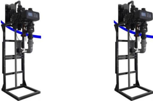
Modèle VTT20SM Upflow Twin Duplex (alterné) Vanne de contrôle d'adoucisseur Affichage : LCD Type d'installation : Montage latéral (Side Mount) Type de contrôle: volume ou temps contrôlé au choix Entrée/Sortie 2" ABS, céramique, distributeurs, vanne de saumure, préfiltre, électrovanne, clapet anti-retour de sortie, cadre de support inclus . Taille du port de saumure : 12,7 mm"
