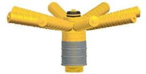
D40SL13042590 Distributeur montage inf. 6" BR 8 bras pour bouteilles 36" Ø90 fentes 0,25 mm
