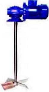
Agitateurs lents sont utilisés dans les usines de traitement des eaux. L'arbre du mélangeur clé est couplée directement avec le creux de la boîte d'engrenage à vis sans fin, fourni avec l'arbre et des lames de rotor 4 de 45e. 3-
