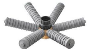
D36TL309A5063 Distributeur montage sup. 6 bras pour bouteilles 36"-42" Ø63 fentes 0,50 mm
