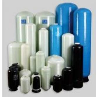
PVA - Bouteille à pression sans base Matière : PE alimentaire - Renforcé fibre de verre Couleur standard : Bleu - Certification : NSF,D.M.174 - Test de cycle minimum : 250.000 cycles de 0 à 10 bar - Pression de fonctionnement max. : 150 psi (10 bars) - Température de fonctionnement max : 45°C Vide max : 140 mm Hg
