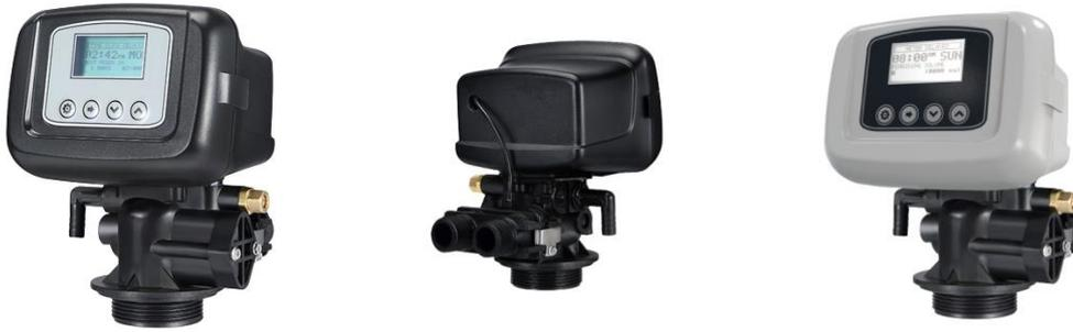
TZ2 série Vanne de contrôle électronique, corps de la vanne en plastique Noryl, entrée ou sortie 1 "ou 3/4", régénération upflow (contre-courante), connexion bouteille 2 1/2 ", débit de service 0.15m<sup>3</sup> / H ~ 3.5m<sup>3</sup> / H (alimentation continue, 0.35 Mpa Inlet), approprié pour réservoirs sous pression de 7 "à 16" (Dia.), Emballage en carton, vannes de 6 vannes volumétriques par carton ou 8 vannes cronométriques par carton. Dimension du carton est de 0,58 \* 0,54 \* 0,26 (m)
