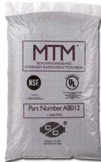
Clack MTM® (sac de 14,15 l) La description Clack MTM® est un média filtrant en dioxyde de manganèse granulaire utilisé pour réduire le fer, le manganèse et le sulfure d'hydrogène de l'eau potable. Son revêtement de surface actif oxyde et précipite le fer et le manganèse solubles. Le sulfure d'hydrogène est oxydé en soufre. Les précipités sont filtrés dans le lit granulaire et éliminés par rétrolavage. PROPRIÉTÉS PHYSIQUES
