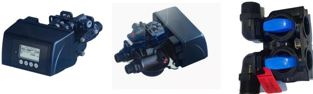
GZ2 série Vanne de contrôle électronique, corps de la vanne en plastique Noryl, entrée ou sortie 1 "ou 3/4", régénération downflow (co-courante), connexion bouteille 2 1/2", débit de service 0.15m<sup>3</sup> / H ~ 3.5m<sup>3</sup> / H (alimentation continue, 0.35 Mpa Inlet), approprié pour réservoirs sous pression de 7 "à 16" (Dia.), Emballage en carton, vannes de 6 vannes volumétriques par carton ou 8 vannes cronométriques par carton. Dimension du carton est de 0,58 \* 0,54 \* 0,26 (m)
