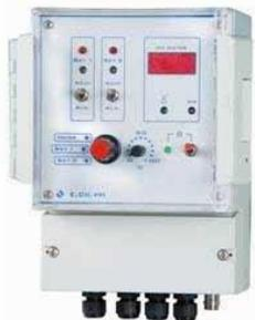
Contrôleur conçu pour mesurer, contrôler et réguler la valeur résiduelle du chlore résiduel - Gamme de mesure 0 ÷ 10 ppm - LCD numérique (3 chiffres) - Régulation de 2 points de consigne d'intervention indépendants - 2 sorties ON / OFF
