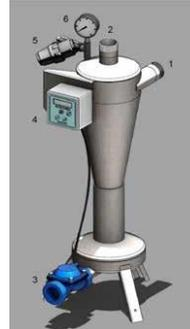
Le filtre hydrocyclone, ou une bague de filtre, ou du sable de séparateur centrifuge, est souvent considéré comme un pré-filtre pour le nettoyage de liquides ou très sablonneux ou saturée avec de l'eau particules solides tels que le gravier, ou de particules généralement plus lourd que l'eau. Il est généralement monté devant une station de filtration lui-même. Aucun entretien particulier, filtrer l'eau à partir de:
