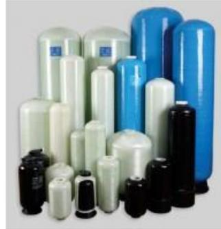
PVA - Bouteille à pression avec base Maériel : PE alimentaire - Renforcé fibre de verre Couleur standard : Bleu - Certification : NSF,D.M.174 - Test de cycle minimum : 250.000 cycles de 0 à 10 bar - Pression de fonctionnement max. : 150 psi (10 bars) - Température de fonctionnement max : 45°C Vide max : 140 mm Hg
